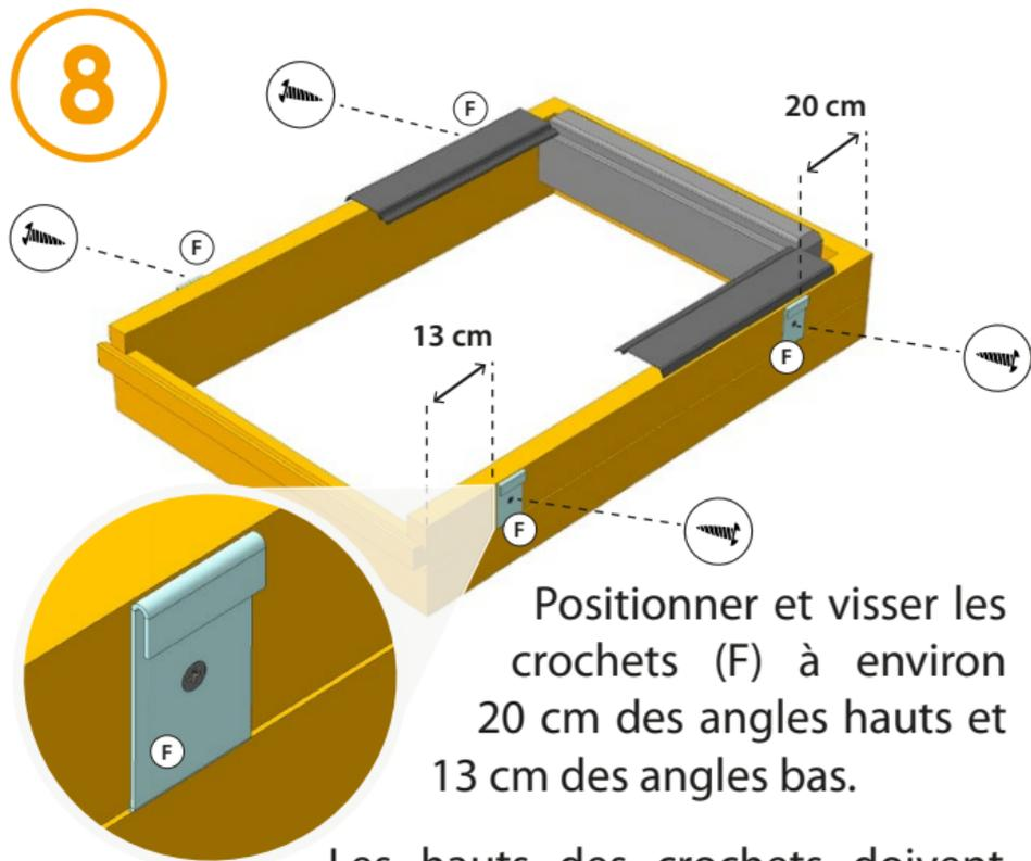
Positionner et visser les crochets (F) à environ 20 cm des angles hauts et 13 cm des angles bas.
