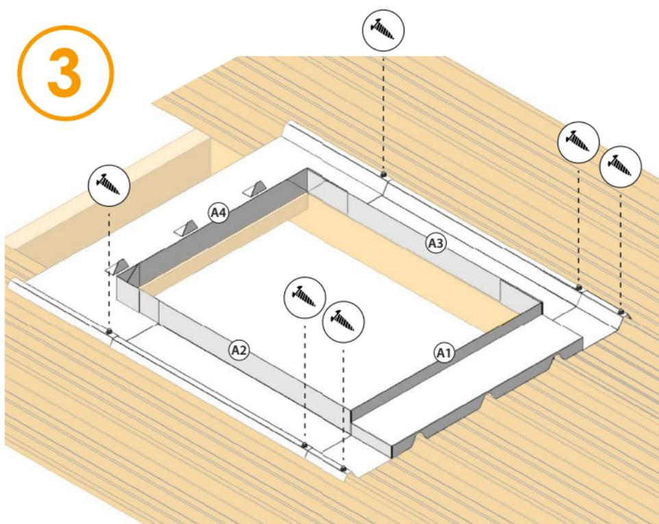
Poser les profils latéraux (A2, A3) et l'élément haut (A4), puis les visser sur le bac.
