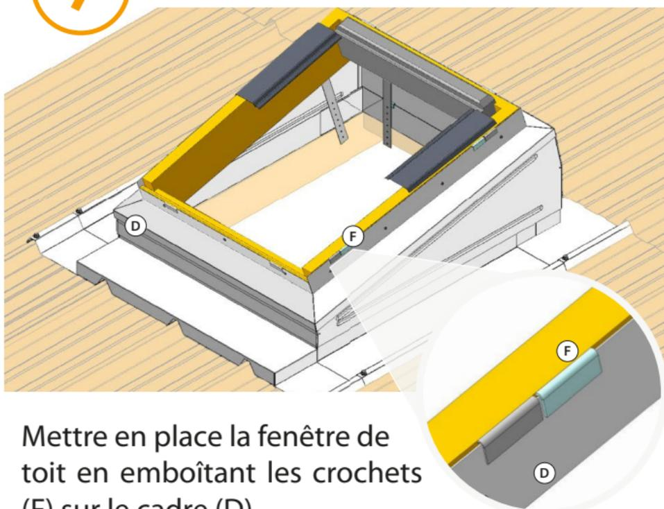
Mettre en place la fenêtre de toit en emboîtant les crochets (F) sur le cadre (D).
