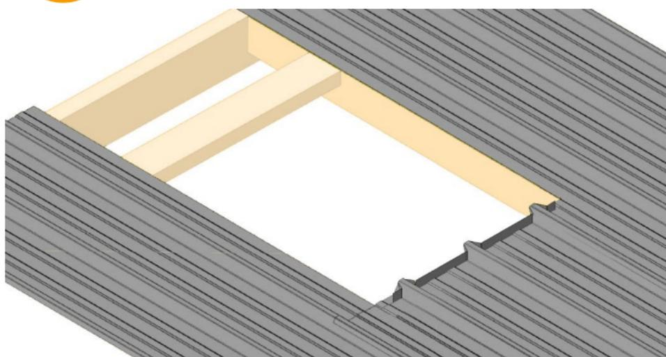
Mettre en place les bacs en périphérie du chevêtre (bas et côtés) puis réaliser un relevé de 4 cm sur la partie basse du chevêtre.
