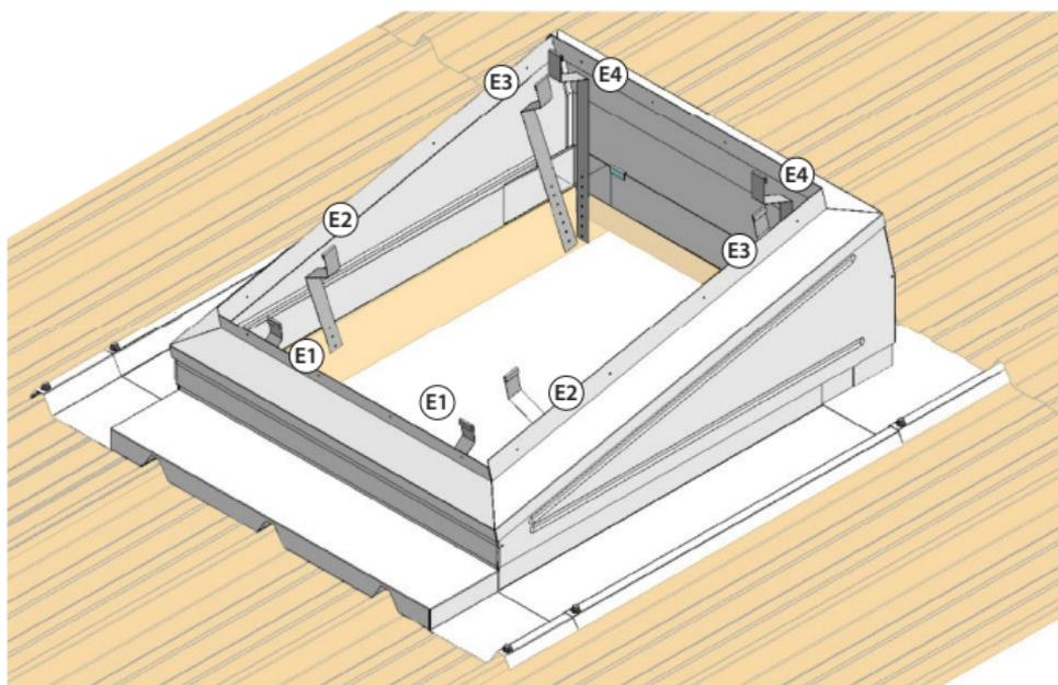
Positionner les crochets (E) en partie haute du cadre (D) et visser la partie basse des crochets au chevêtre.
