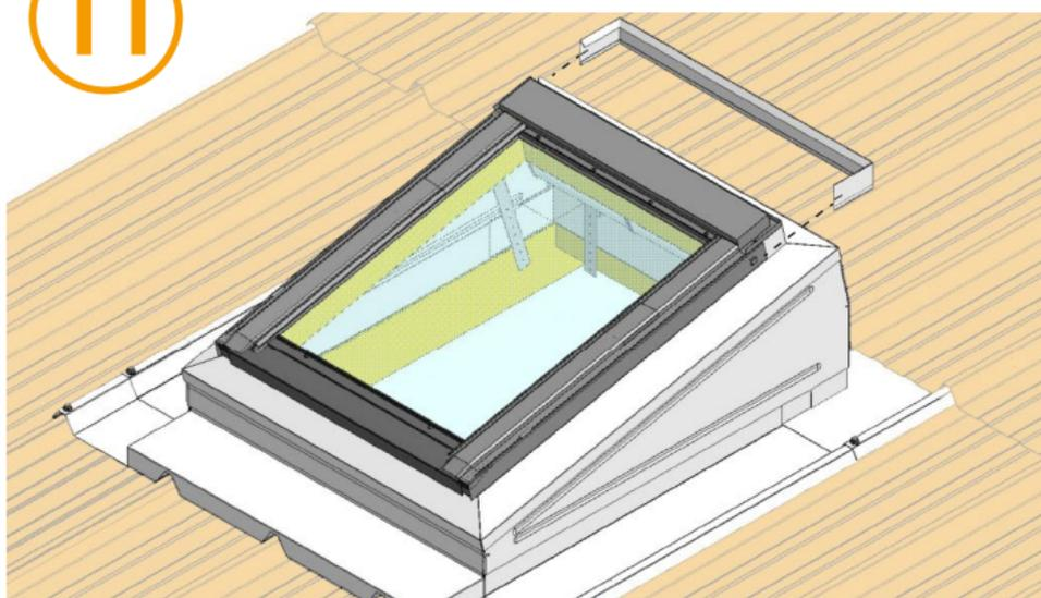
Mettre en place les profilés périphériques de la fenêtre de toit puis installer l'ouvrant de la fenêtre de toit.
