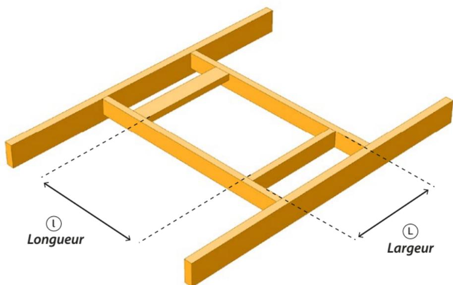
Commencer par réaliser le chevêtre en respectant les cotes données en fonction du modèle de la fenêtre.
