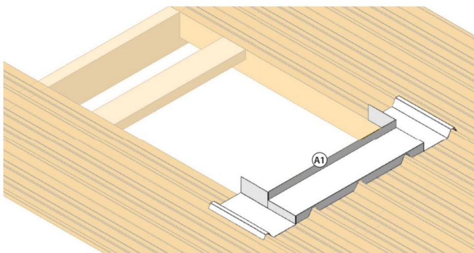
Poser l'élément bas (A1) du raccord bac acier.
