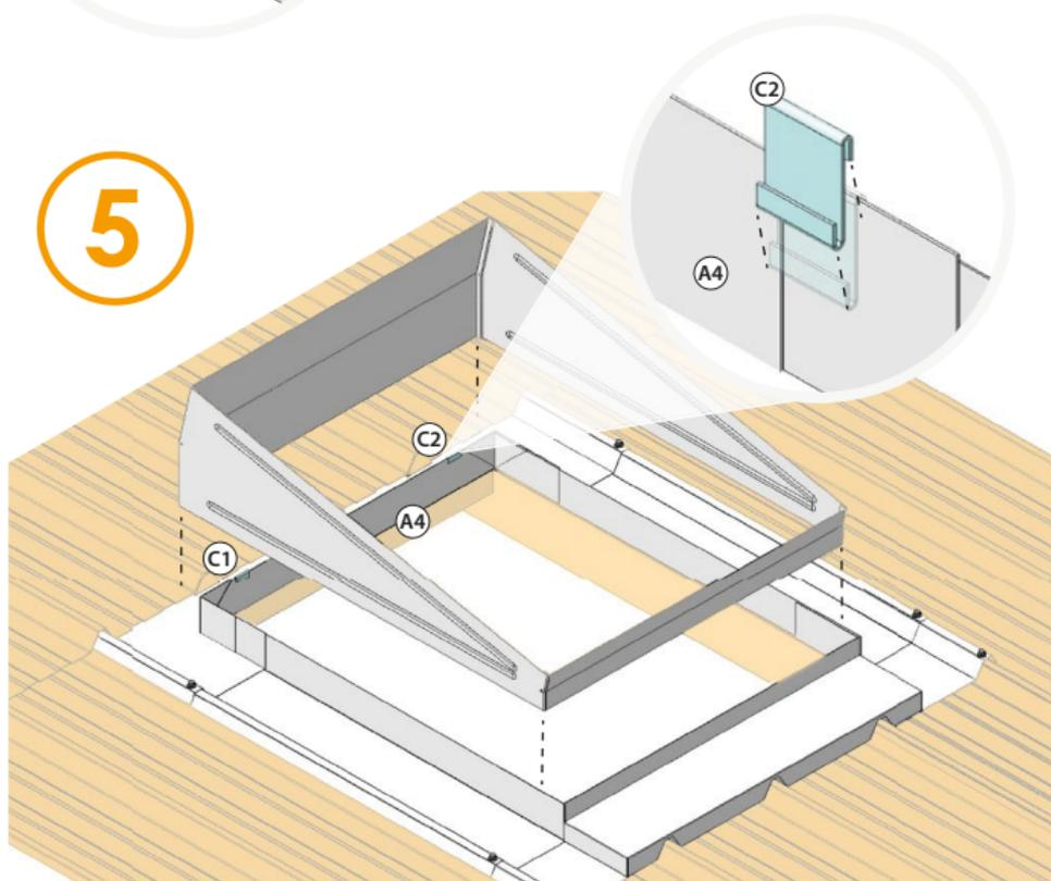
Positionner les 2 crochets C1 et C2
