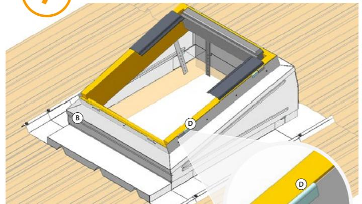
Mettre en place la fenêtre de toit en emboîtant les crochets (D) sur le cadre (B).
