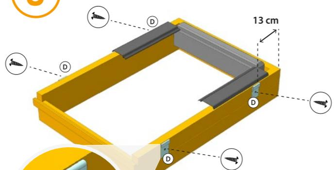
Positionner et visser les crochets (D) à environ 13cm des angles.
