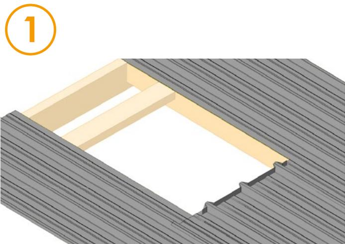
Mettre en place les bacs en périphérie du chevêtre (bas et côtés) puis réaliser un relevé de 40cm sur la partie basse du chevêtre.
