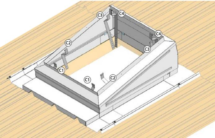
Positionner les corchets (C) en partie haute du cadre (B) et visser la partie basse des crochets au chevêtre.
