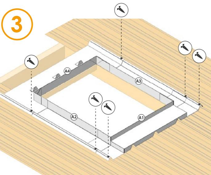
Poser les profils latéraux (A2, A3) et l'élément haut (A4), puis les visser sur le bac.
