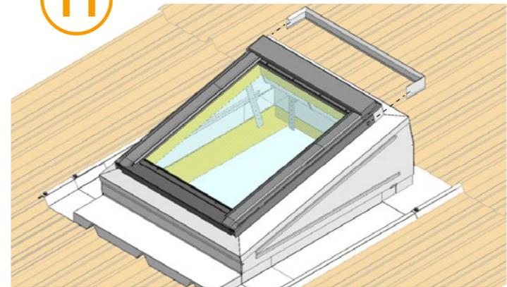
Mettre en place les profils périphériques de la fenêtre de toit puis installer l'ouvrant de la fenêtre de toit.
