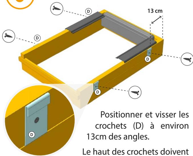
Positionner et visser les crochets (D) à environ 13cm des angles.
