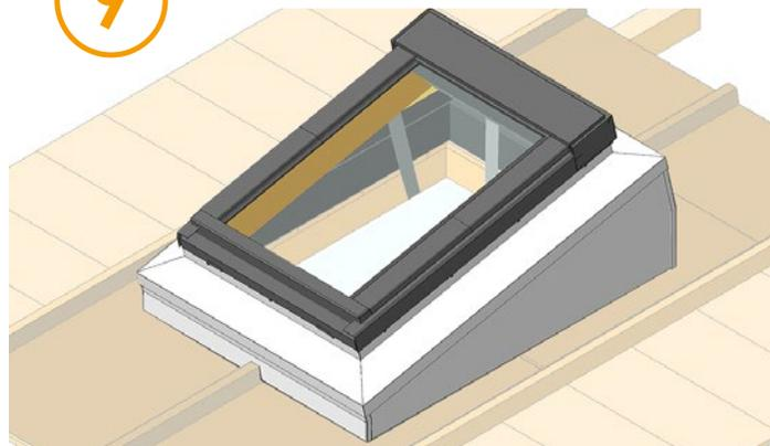
Mettre en place les profilés latéraux puis installer l'ouvrant de la fenêtre de toit.
