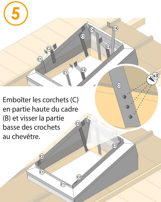
Emboîter les crochets (C) en partie haute du cadre (B) et visser la partie basse des crochets au chevêtre.
