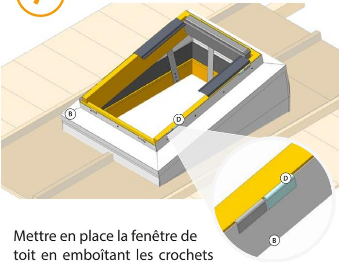
Mettre en place la fenêtre de toit en emboîtant les crochets (D) sur le cadre (B).
