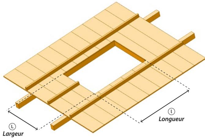
Commencer par réaliser le chevêtre en respectant les cotes données en fonction du modèle de la fenêtre.
